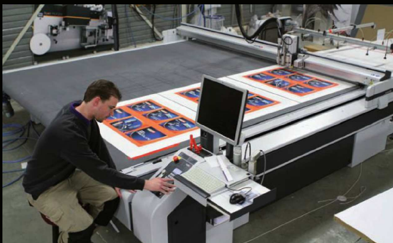
De Zünd G3 snijtafel met lopende band dient tevens als back-up voor de Cosign-tafel.
