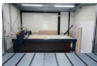
Voor de router is een afsluitbare ruimte gemaakt
